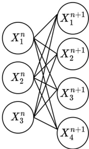
$$\vec{X}^{n+1} := \phi^{n+1}(\vec{Z}^{n+1}) = \begin{bmatrix} \phi^{n+1}(Z_1^{n+1}) \\ \phi^{n+1}(Z_2^{n+1}) \\ \phi^{n+1}(Z_3^{n+1}) \\ \phi^{n+1}(Z_4^{n+1}) \end{bmatrix}$$
